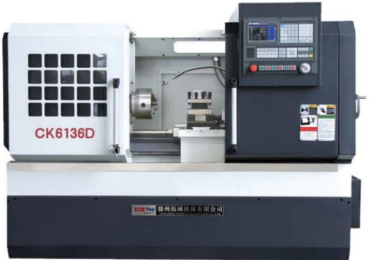
La máquina es de integración mecánica y eléctrica. Los elementos de ejecución son controlados por el sistema CNC para cortar la superficie, como cilindro interno y externo, cono, de cara, tornillo u otra forma redonda, por lo que se puede utilizar ampliamente en mecánica, dispositivos, industria ligera e instrumentos. Es ideal si lo que se busca es trabajar lotes de producción medianos o pequeños.
